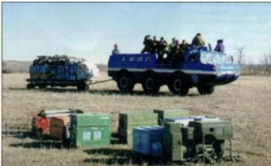
ПЭМ-1 оснащена не только мощным двигателем, развивающим скорость движения по грунту 80—90 км/ч, по воде до 15 км/ч, но имеет еще и трехосное всепроходимое шасси, на котором с ходу берет траншеи до 2 метров шириной, а
